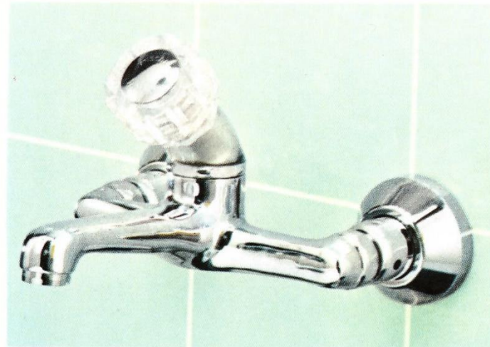
09 26 00 Wandbatterie mit festem Auslauf, in den verstellbaren Exzenter- Anschlüssen sind Vorregulier- ventile enthalten
