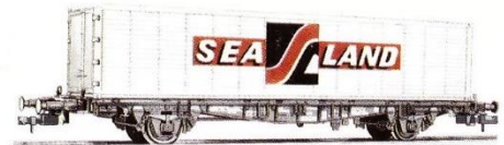
Container-Tragwagen Lbs 598 mit 40' Iso-Alu-Container Sealand, abnehm- und kranbar. 7301 DM 14,50
