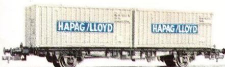
DB-Container-Tragwagen Lbs 598 wie Modell 7003 jedoch mit 2 x 20' Stahl-Containern. 7001
